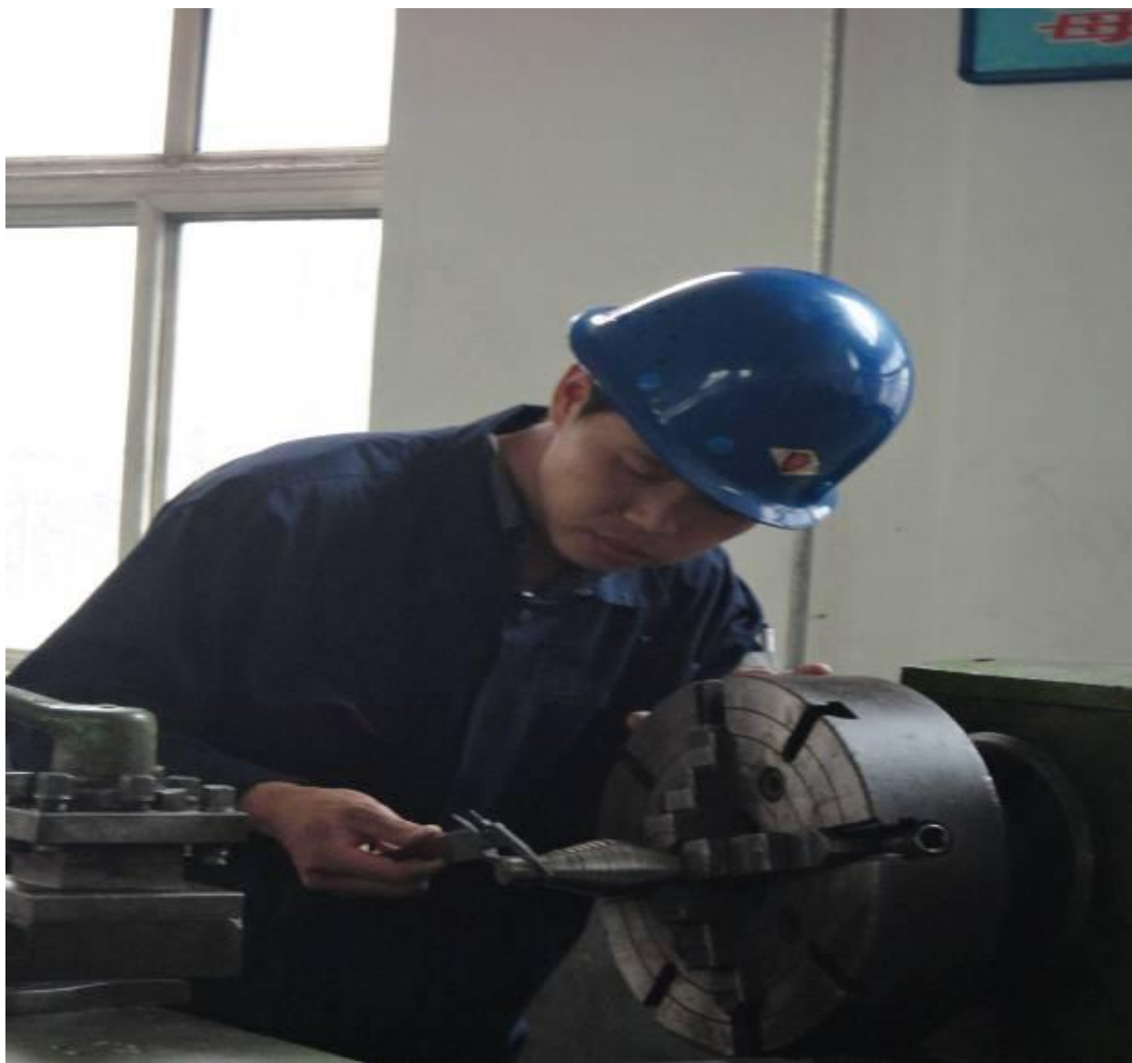
安琪老师参加岗位技能培训，加工阶梯轴件照片
